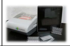
μCulture®結合細胞/組織培養、 微流體生物晶片及電機等相關領 域的知識及技術,並整合了許多 細胞培養的新概念(微型化/灌流 式/三維細胞培養),旨在開發一 項能提供穩定、均一、仿生、高 通量化、低實驗資源需求及操作 方便的高效能細胞培養工具。
